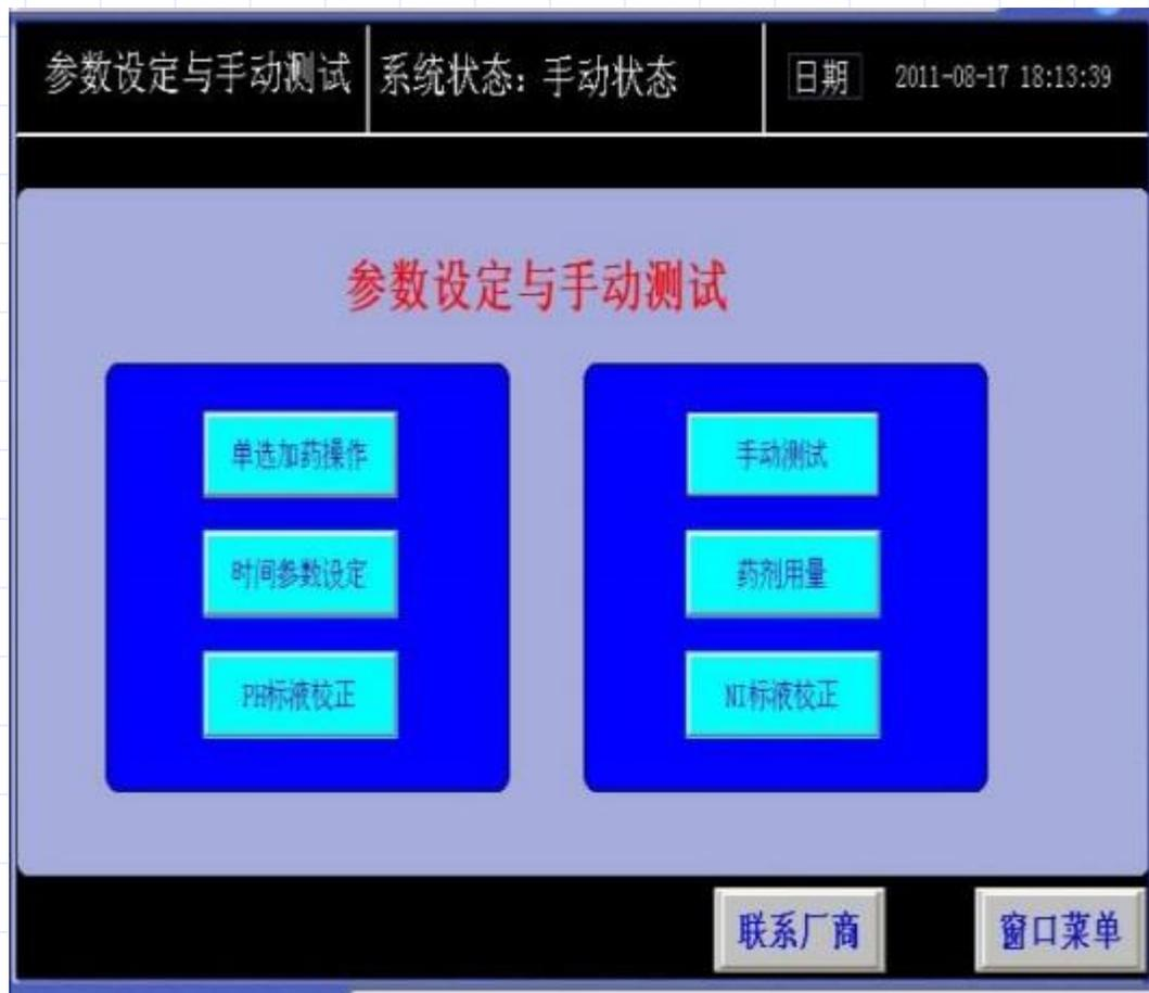
注：手动添加功能，可单独添加任意几种。手动测试电器功能是否正常运行。添加时间及取样品药时间参数。药剂添加量，报警设置。PH、NI的单点、双点校正。
